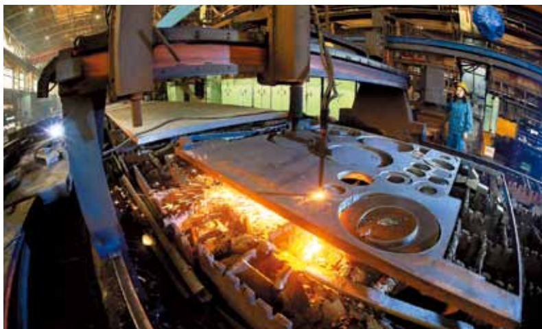
一家位於濟南市之大型生產商採用天然氣金屬切割技術切割機械設備。
