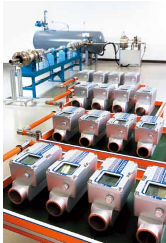
卓度計量之新一代燃氣錶採用微機電系統質量計量技術，使計量更準確，其位於廣東省龍崗區之生產廠房現已投產。
