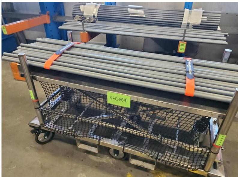
煤氣公司研發的「自動升降管材運輸車」可以有效減少員工彎腰處理管材的次數，更能保障員工的健康。
