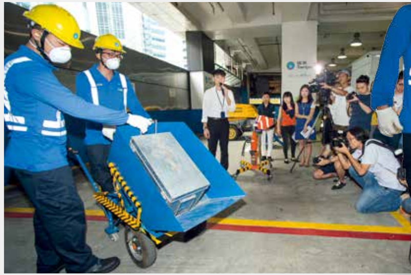
經改裝的「電動運泥車」以電力推動，前方雙輪驅動，後方添加兩個輔助輪作四點支撐。另外，「電動運泥車」加裝油壓支架和剎車功能，使操作更穩定。
