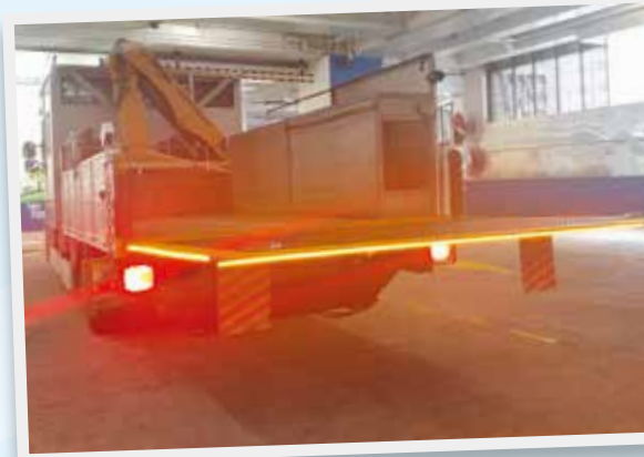
在貨車尾板及輕型貨車尾門安裝「圍邊 LED 自動閃燈」，有助減低因後車未有注意尾板位置而發生碰撞事故的風險。
