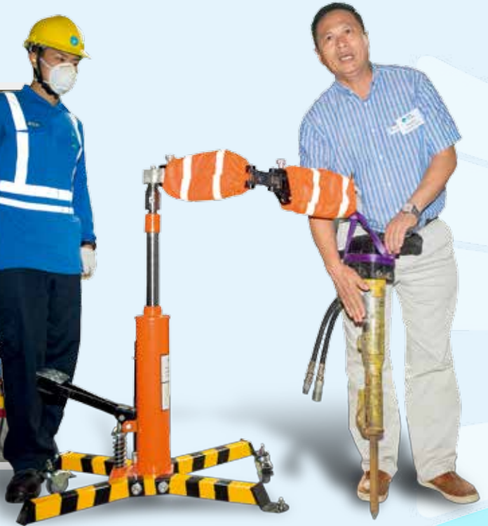
「機械臂」可有效減輕風砲負重和震動造成勞損。
